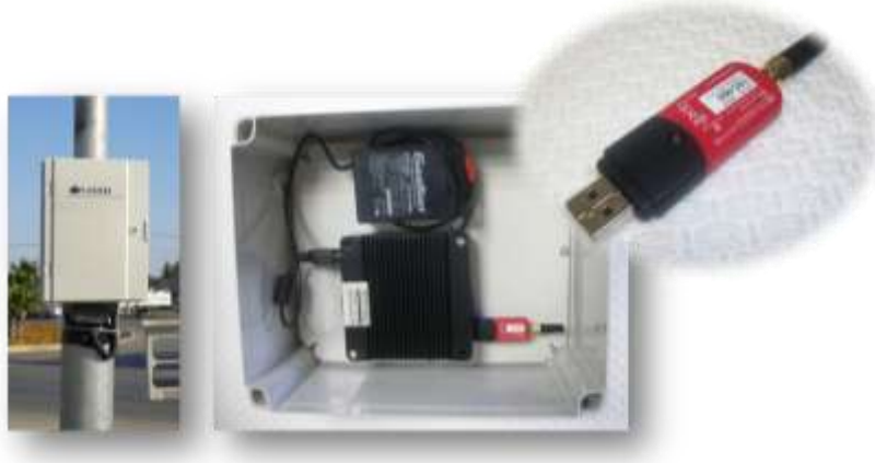
Şekil 2 Sınıf 1 Bluetooth okuyucusu (çekim alanı 300m)
